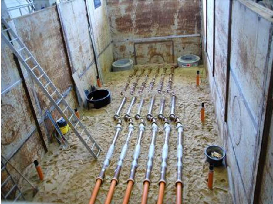
Abbildung 4: Tiefste Rohrlage vor der Überschüttung, Überschüttungshöhe 5 m
