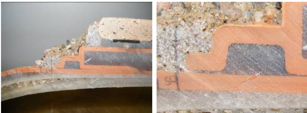
Abbildung 2: Harzaustritt aus einer undichten Verbindung
