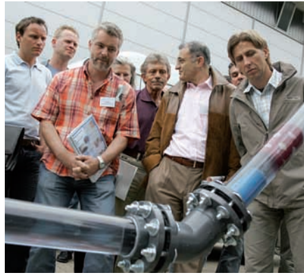
Molch unter Beobachtung: Wie sich ein Reinigungsmolch zuverlässig auch durch verwinkelte Druckleitungen mit Schieberarmaturen und 90 Grad Bögen arbeitet, war anhand einer auf dem IKT-Gelände aufgebauten Testleitung aus Plexiglas deutlich zu sehen.
