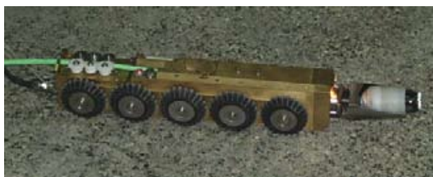
Abb. 26: Satellitensystem für Leitungen ab DN 135 der Firma Cues Europa B.V.
