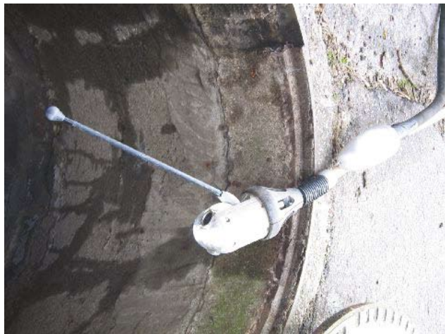
Abb. 24: „Kieler Stäbchen“ der Firma IBAK GmbH & Co. KG
