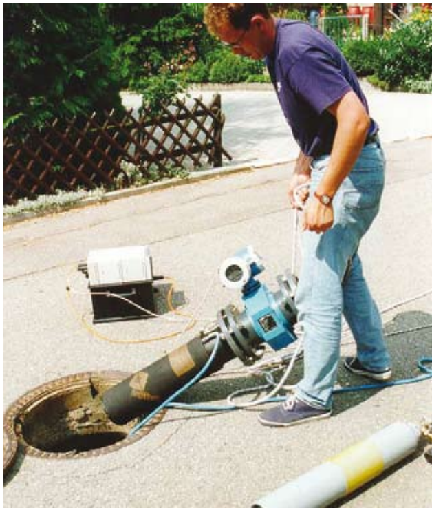
Abb. 5: Mobile magnetisch induktive Durchflussmessung (MID) mit Absperrblase (für kurz- und langfristige Messungen) 2 (Quelle: Axel Zangenberg)
