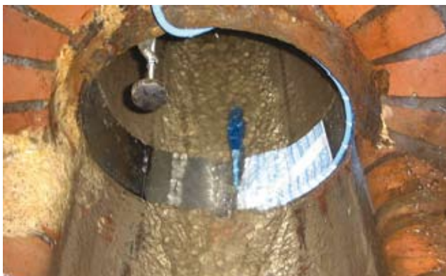
Abb. 4: Ultraschall-Doppler-Sensor mit Schnellmontagesystem (für kurz- und langfristige Messungen) (Quelle: Nivus)
