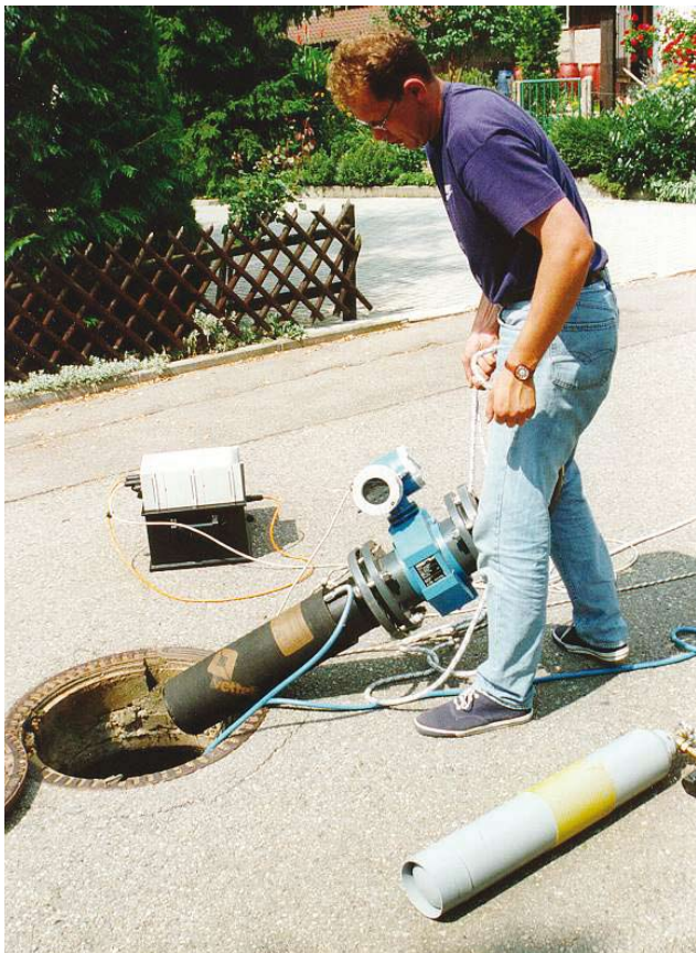
Abb. 16: Mobiler MID mit Absperriblase
