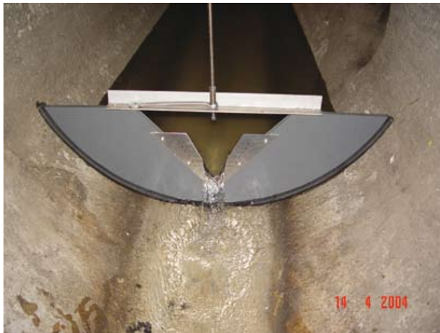
Abb. 18: „Mobiles“ Dreiecksmesswehr in PVC-Messschablone
