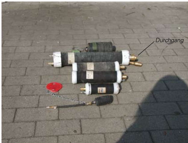
Abb. 62: Zylindrische Absper- und Durchgangsbblasen
