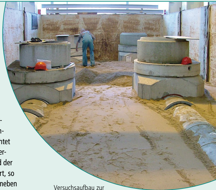
Versuchsaufbau zur Mindestüberdeckung von Kanälen
