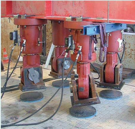
Bild 9 Lasteinleitung für den Lastfall „Radgruppe statisch“
