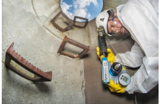
IKT prüft insitu die Haftzugfestigkeit einer Schachtbeschichtung.
