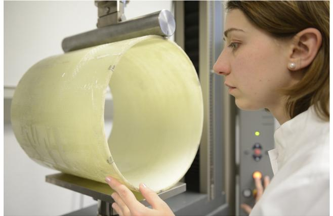
Untersucht werden Schlauchliner-Proben von Baustellen. Diese werden nach Aushärtung des Liners entnommen und zum **IKT-Labor** geschickt. Dort ermitteln IKT-Prüfer die Kennwerte E-Modul, Biegefestigkeit, Wanddicke und Wasser-Dichtheit der Proben. Der Auftraggeber erhält darüber ein detailliertes Gutachten.
