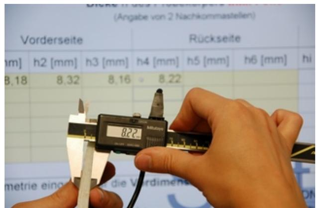
Mit Präzisionsschieblehre wird Liner-Wanddicke gemessen
