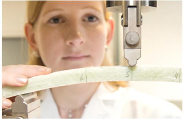
Drei-Punkt-Biegeversuch an Schlauchlinerprobe
