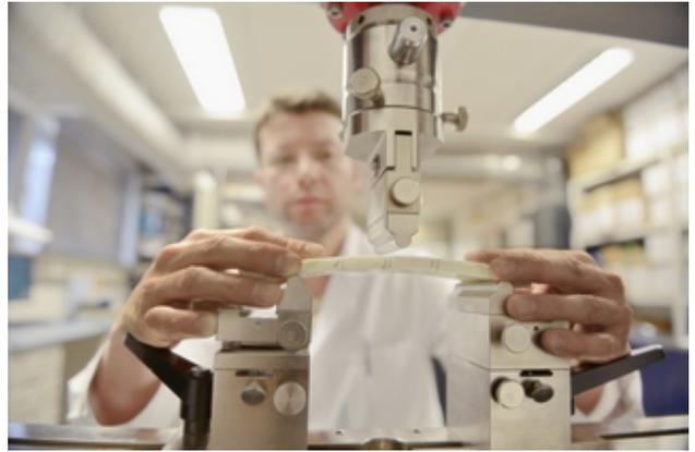
Drei-Punkt-Biegeversuch an Schlauchliner
