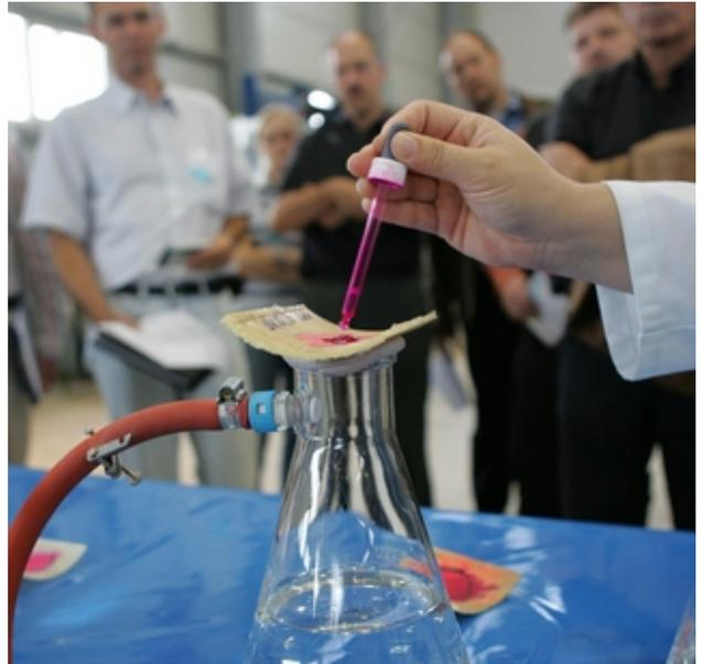
Wasserdichtheitsprüfung an Schlauchliner
