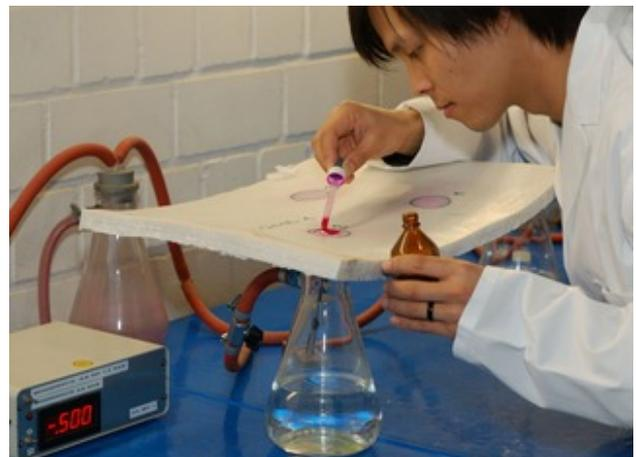
Wasser-Dichtheitsprüfung an Schlauchliner mit 0,5 bar Unterdruck und roter Prüf­flüssigkeit
