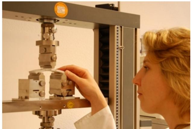
Drei-Punkt-Biegeversuch an Schlauchliner
