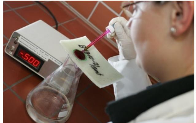
Prüfung der Wasserdichtheit an Schlauchliner
