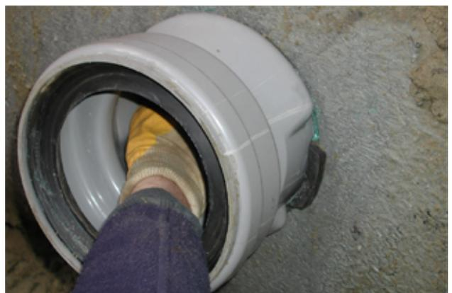
Hausanschluss-Stutzen im Test
