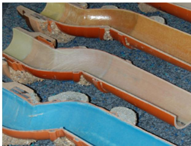
Anschaulich: Proben aus dem Warentest zeigen Liner, Rohr und ausgetretenes Harz
