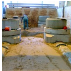
Versuchsaufbau: Untersuchungen zur Mindestüberdeckun- g von Kanälen
