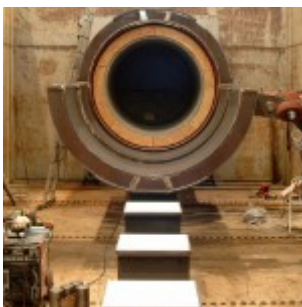
Aufbau des Rohrvortriebssimu- lators im Großversuchsstand
