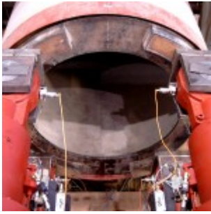
Vorpresstation des Rohrvortriebssimu- lators
