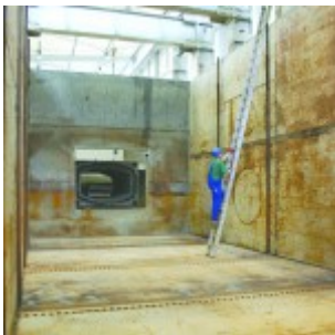
18x6x6 Meter: der IKT- Großversuchsstand
