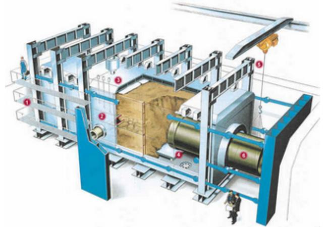
IKT-Großversuchsstand: Länge 18m, Breite 6m, Tiefe 6m
