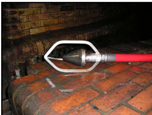
Abb. 11: Kanalreinigungsdüse mit Kufen zur schonenden Reinigung sanierter Kanäle
