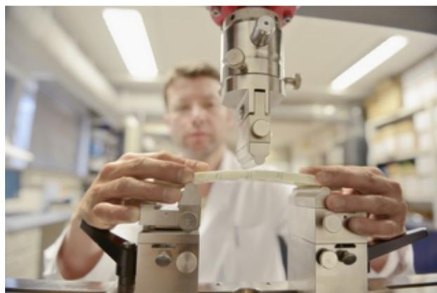
Drei-Punkt-Biegeversuch an Schlauchliner
