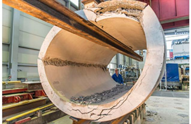
Scheiteldruckprüfung an Stahlbetonrohr
