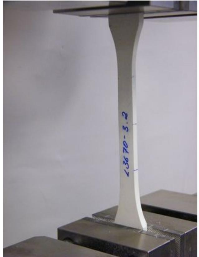
Zugversuch an einer Harzprobe
