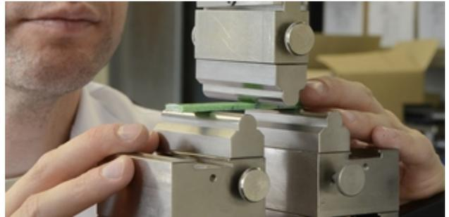
Drei-Punkt-Biegeversuch an einer Kunststoff-Probe
