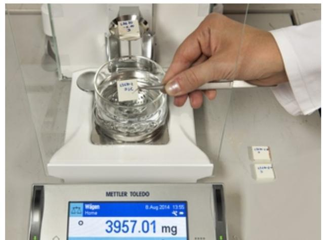
Präzisionswaage zur Bestimmung des Spezifischen Gewichts (Dichte)
