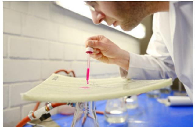
Wasserdichtheitsprüfung einer Schlauchliner-Probe im IKT-Labor
