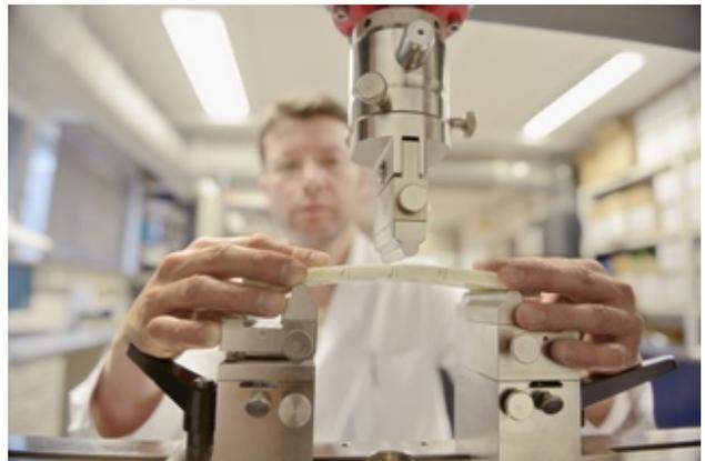
Drei-Punkt-Biegeversuch an Schlauchliner
