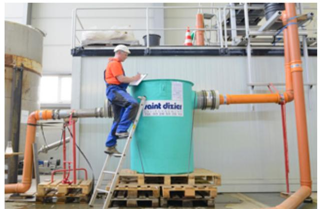
Dezentrale Behandlungsanlage auf dem IKT-Prüfstand
