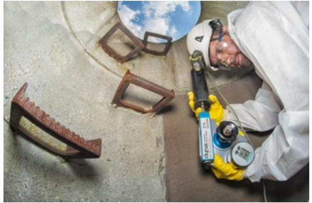
IKT prüft insitu die Haftzugfestigkeit einer Schachtbeschichtung
