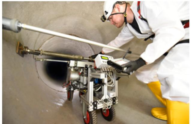
Mit dem MAC-System in Rohr und Boden „schauen“: Zerstörungsfreie Prüfung der Standicherheit von großen Kanälen
