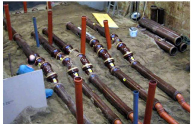
Aufbau eines Leitungsnetzes im IKT-Großversuchsstand
