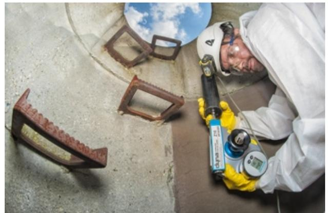
IKT prüft die Haftzugfestigkeit einer Schachtbeschichtung
