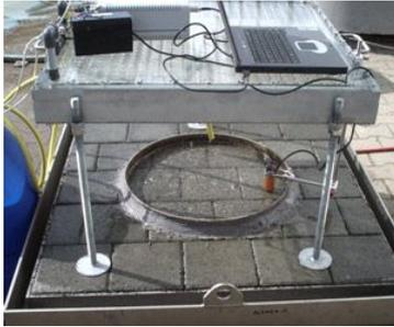
Um weitere Vergleichsmöglichkeiten zur Prüfung vor Ort zu schaffen und darüber hinaus einen Vergleich zwischen der Prüfanlage und dem Tropfinfiltrometer zu ermöglichen, wurde das Tropfinfiltrometer über dem waagrecht ausgerichteten Wechselrahmen platziert (s. Abb. 47) und der Belag entsprechend der In-situ-Untersuchungen (vgl. Kap. 6.2) geprüft.
