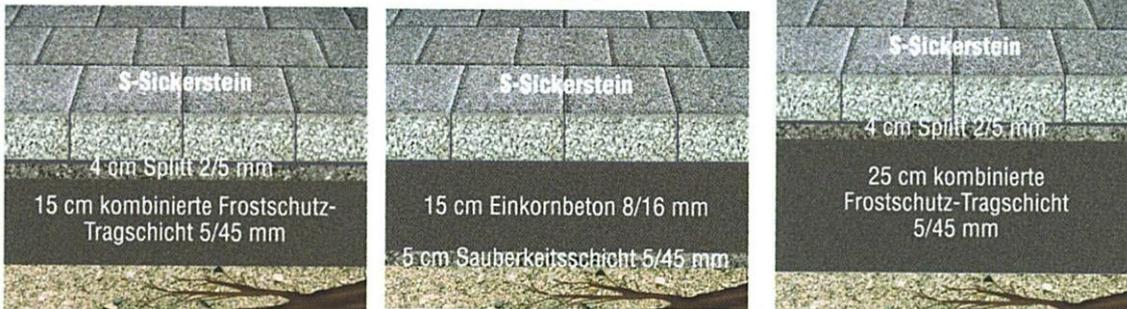
**Abb. 7:** Aufbau für wasserdurchlässigen Boden im Bereich von leichtem Verkehr, von Zufahrten und von Pkw-Stellplätzen [9]
