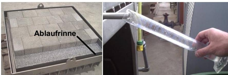
**Abb. 45:** Ablaufrinne (links) und Auffangen des Wassers der Ablaufrinne (rechts)
