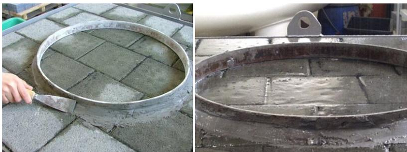
**Abb. 46:** Aufbringen des Rings (links) und Beregnung (rechts)
