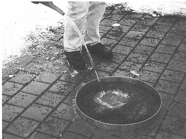
**Abb. 15:** Befüllen des Rings beim vereinfachten Verfahren [7]
