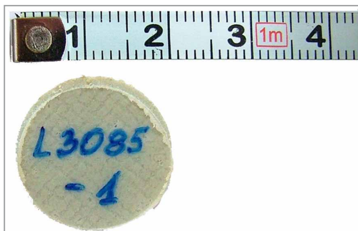
Zkušební vzorek pro analýzu DSC: potřebný průměr 20 mm
