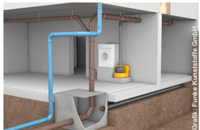
Abhängen von Abwasserrohren unter der Kellerdecke
