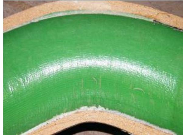
Steinzeug-Bogen 45°, DN 125, Sohlbereich vertikal angeordnet
