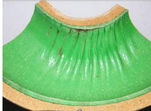
Steinzeug-Bogen 90°, DN 125, vertikal angeordnet
