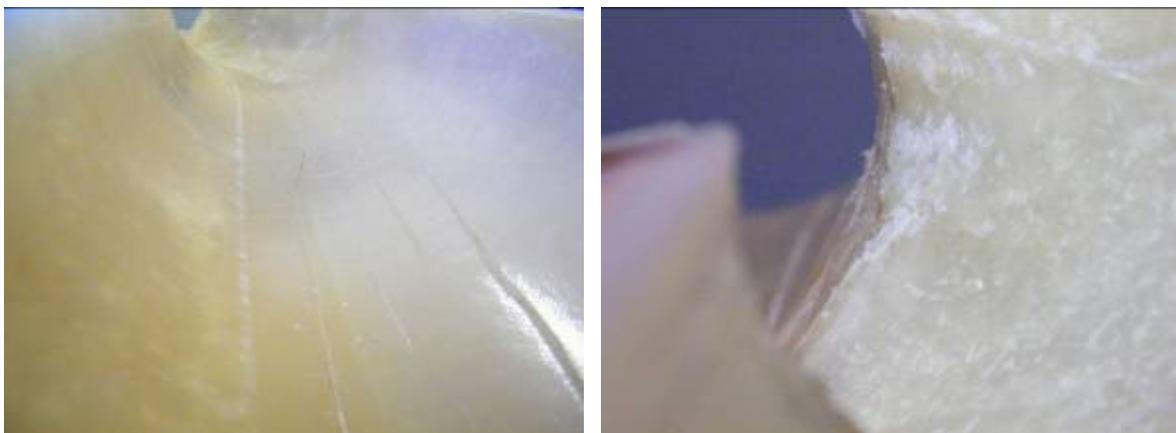
Abbildung 52: Hausanschlussliner nach dem Einsatz der Kettenschleuder
