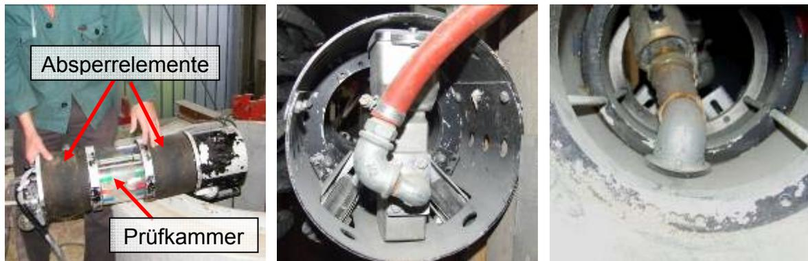
Abbildung 81: Durchflussmessgerät (links); Detailansicht des eingebauten MID (mitig); Auslass aus der Prüfkammer (rechts)
