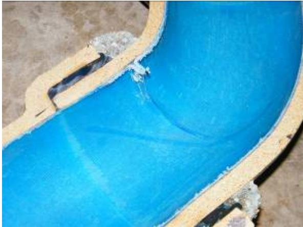
Steinzeug-Bogen 45°, DN 125, Sohlbereich vertikal angeordnet
