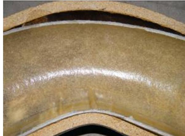
Steinzeug-Bogen 45°, DN 125, Sohlbereich vertikal angeordnet
