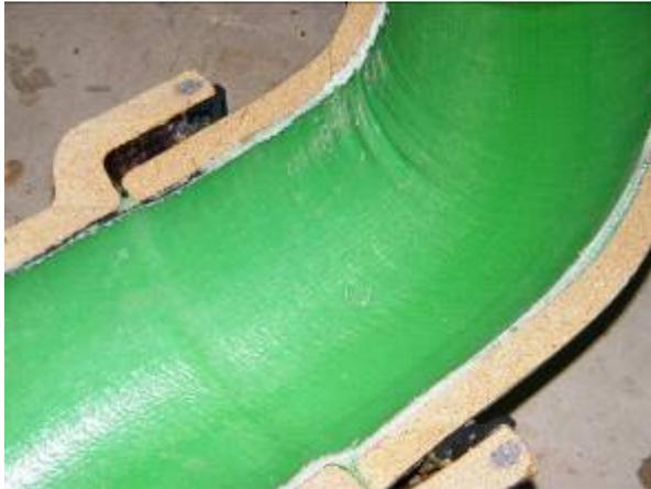
Steinzeug-Bogen 45°, DN 125, Sohlbereich vertikal angeordnet
