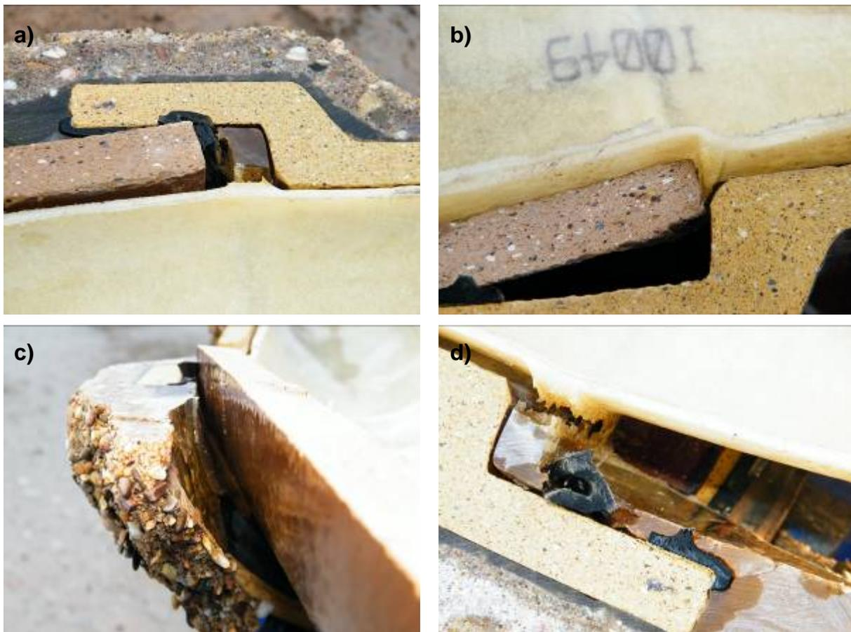
Abbildung 70: Aufgesägter Rohrverbindungsbereich im Bereich **ohne** Undichtigkeit
