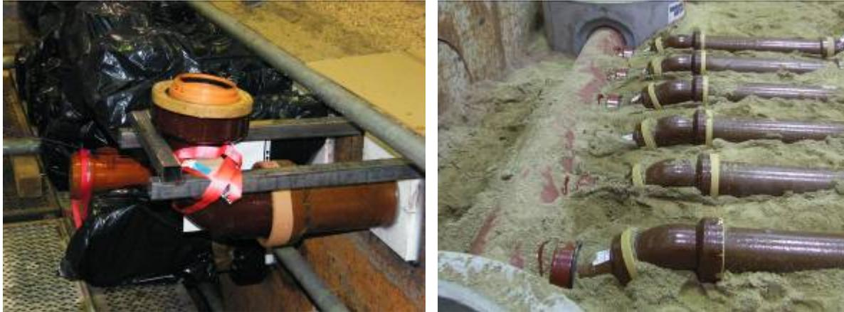
Abbildung 80: Leitungsende im Hochpunkt der Leitung (links)
