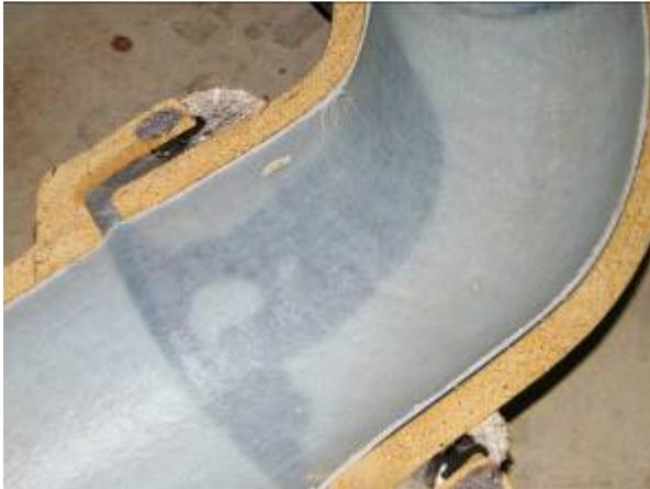
Steinzeug-Bogen 45°, DN 125, Sohlbereich vertikal angeordnet
