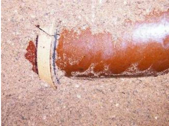
Abbildung 68: Rohrverbindungsbereich mit Undichtigkeit während des Ausbaus
