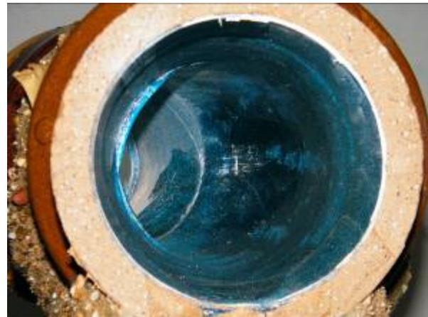
Steinzeug-Bogen 30°, DN 150, horizontal angeordnet, Scherbenbildung in der Sohle, gegen Fließrichtung
