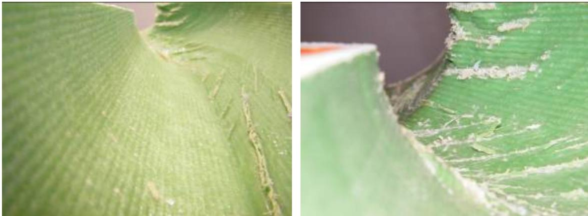
Abbildung 51: Hausanschlussliner nach dem Einsatz der Kettenschleuder
