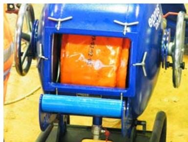
o) Kalibrierschlauch in der Inversionstrommel
