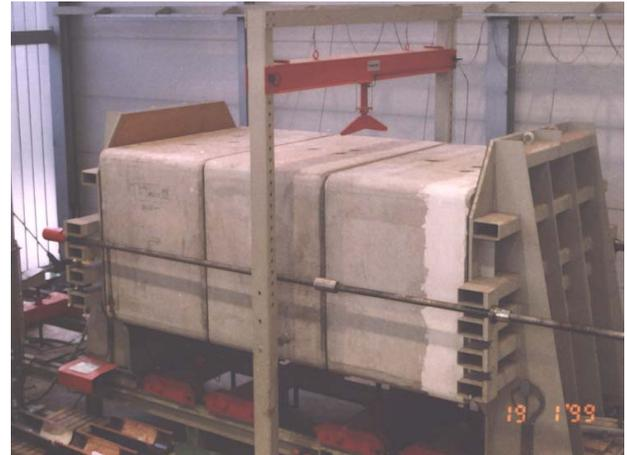
*Bild 1 Innendruckprüfeinrichtung mit eingebauten Stahlbetonrohren*
