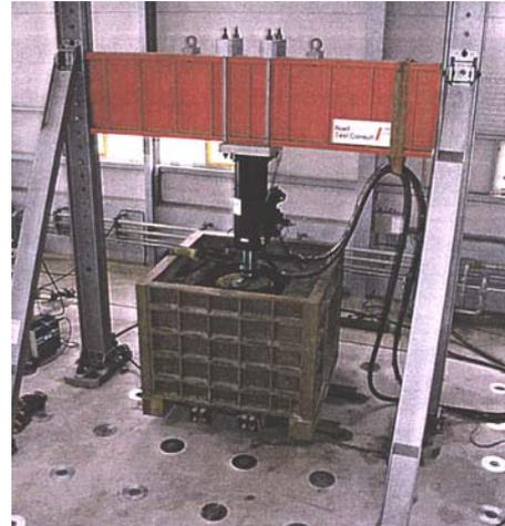
*Bild 3 Einleitung von Vertikal- bzw. Horizontallasten in eine Schachtabdeckung*
