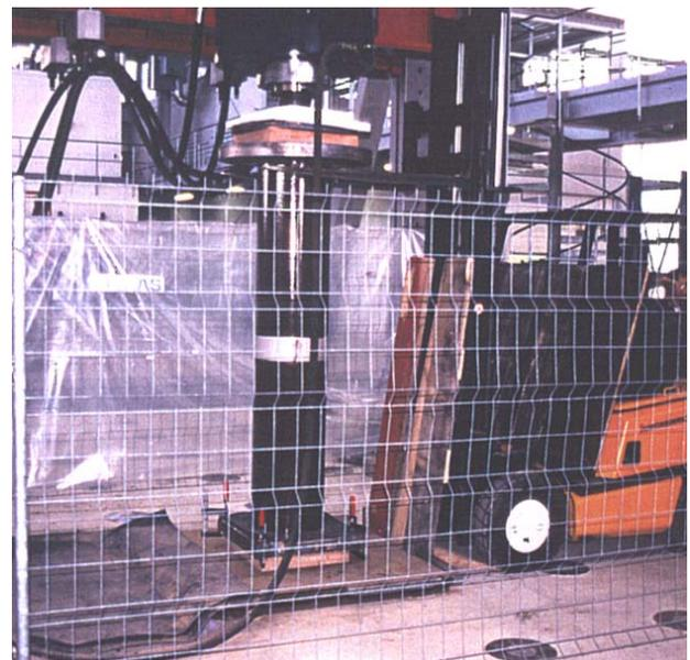
*Bild 2 Axiale Druckversuche an Vortriebsrohren*
