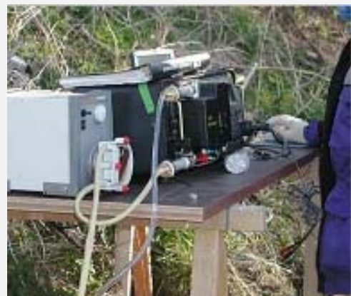
Fluoreszenzspektrometer zur Durchflussbestimmung mittels Tracer
