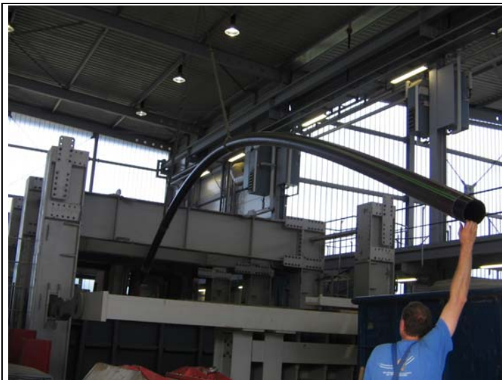
Abb. 14: Einzug ausgehend vom Schacht im Großversuchsstand des IKT
