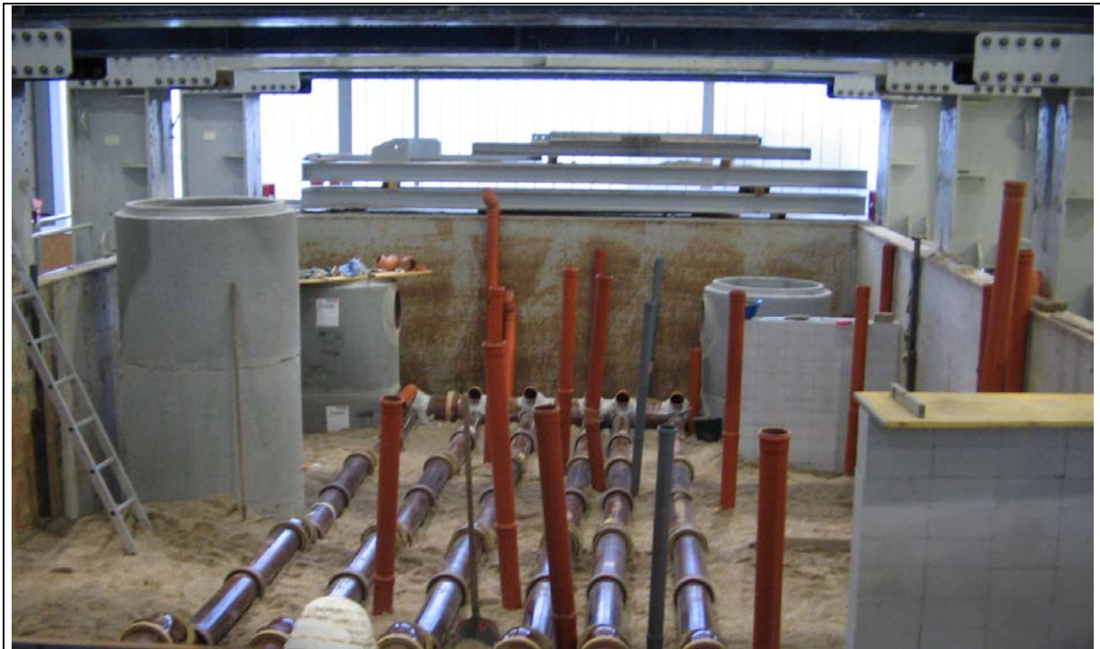
Abb. 8: Versuchsvorbereitungen im IKT-Großversuchsstand: Zugangsschächte und Fallleitungen zu drei Grundstücksentwässerungsnetzen in 6 m Tiefe; Hausanschlussleitungen der zweiten Ebene (abgebildet 6 Leitungen von insgesamt 36); Mauerwerkshindernisse für Bohrverfahren
