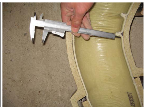
Abb. 10: Faltenmessung nach Ausbau der Liner
