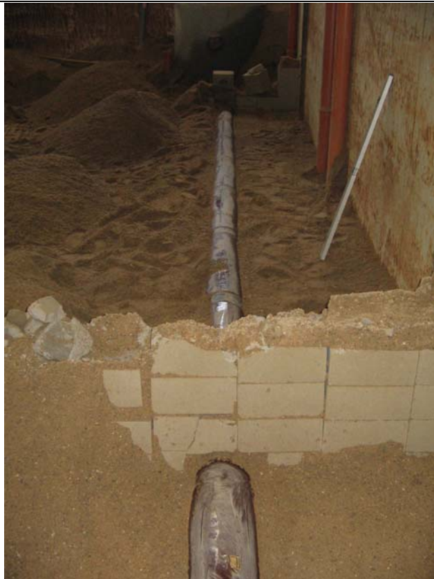
Abb. 13: Freigelegte Bohrtrasse mit eingebauten Hindernissen aus Mauerwerk im IKT-Großversuchsstand
