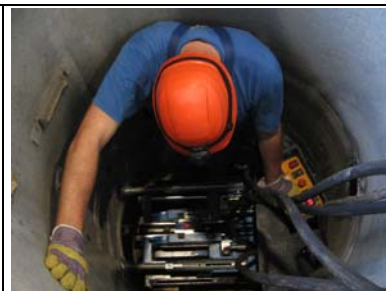
Abb. 14: Einzug ausgehend vom Schacht im Großversuchsstand des IKT
