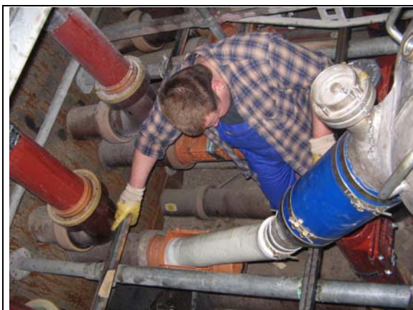
Abb. 9: Inversion im IKT-Großversuchsstand
