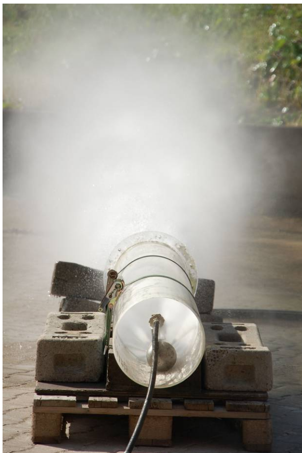
Druck- und Durchflussmessung unmittelbar an der Düse
