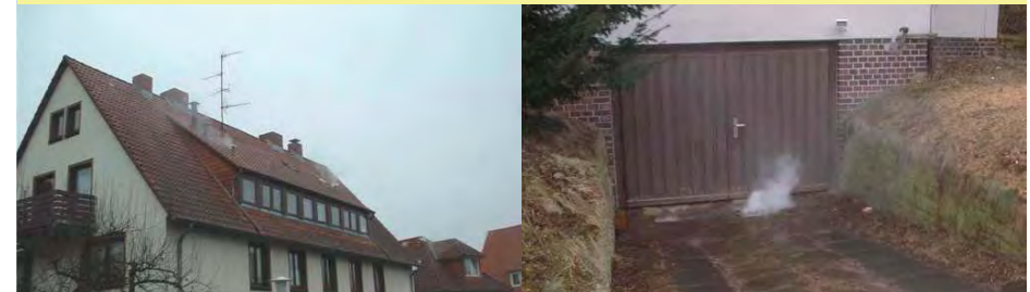
Oben: Nachweis Regenableitung von der Strasse aus Unten: Nebeln öff. SWK – links ohne und rechts mit Fehlanchluss
