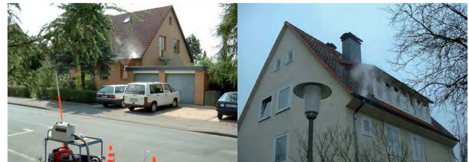
Oben: Nachweis Regenableitung von der Strasse aus Unten: Nebeln öff. SWK – links ohne und rechts mit Fehlanchluss
