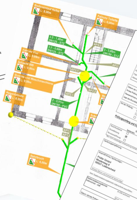
Bezeichnung Dichtungsprüfung gem. § 61 a Landeswassergesetz NRW
