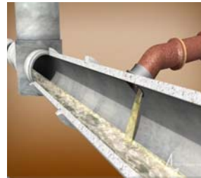
Grund Anlagen hängen direkt zusammen Sanierung nur als Einheit sinnvoll
