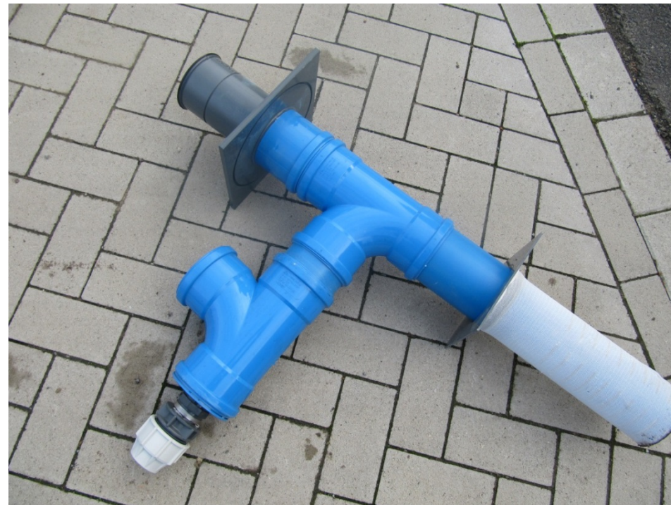
Kombination aus Bewässerung und Belüftung, Grünflächenamt Stadt Bielefeld.
