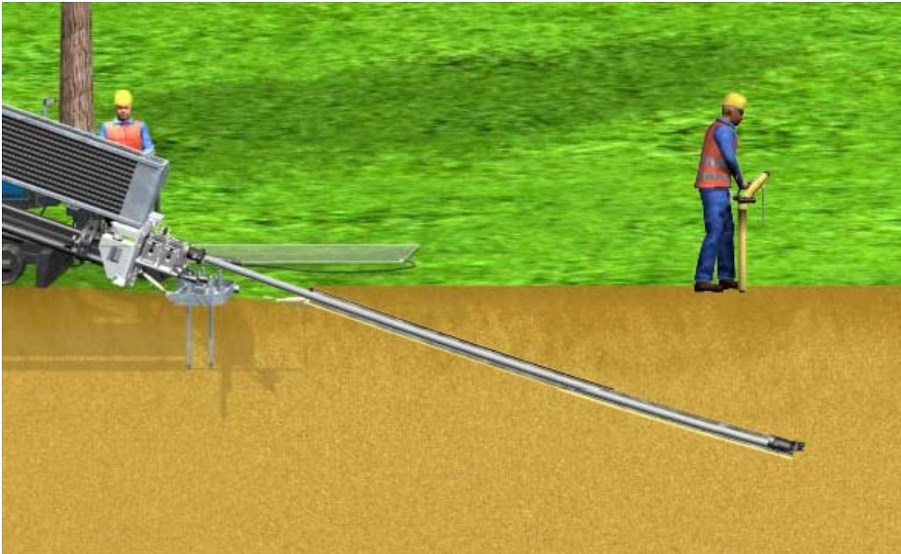
HDD - Spülbohrverfahren für alle Leitungstrassen
