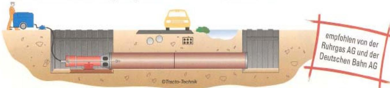
Das Stahlrohr-Rammverfahren mit
