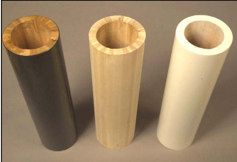
a) Formholzrohre vlnr CFK, natur, GFK
