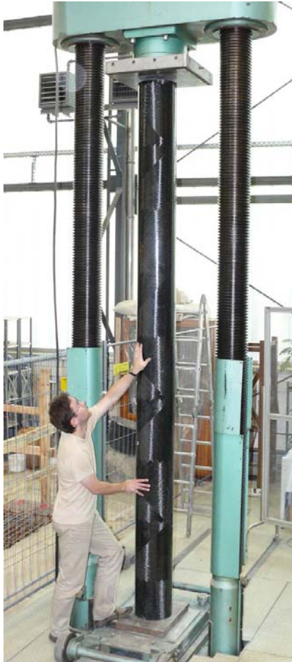
Versuchsaufbau, CFK-bewehrtes Formholzrohr, Länge 3800 mm
