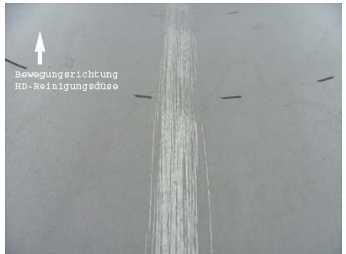
Probekörper 2 nach 30 Belastungszyklen
