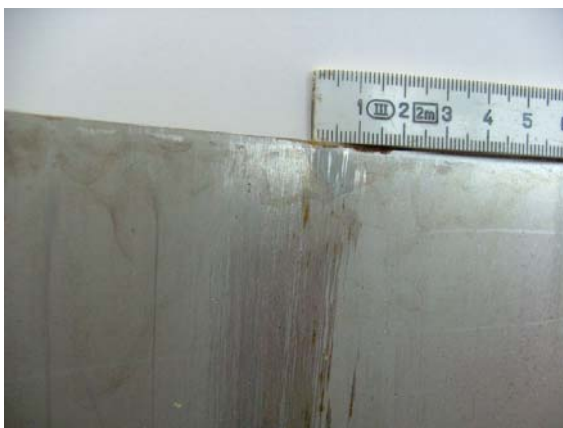
C 4 cm Breite Schleifspur
