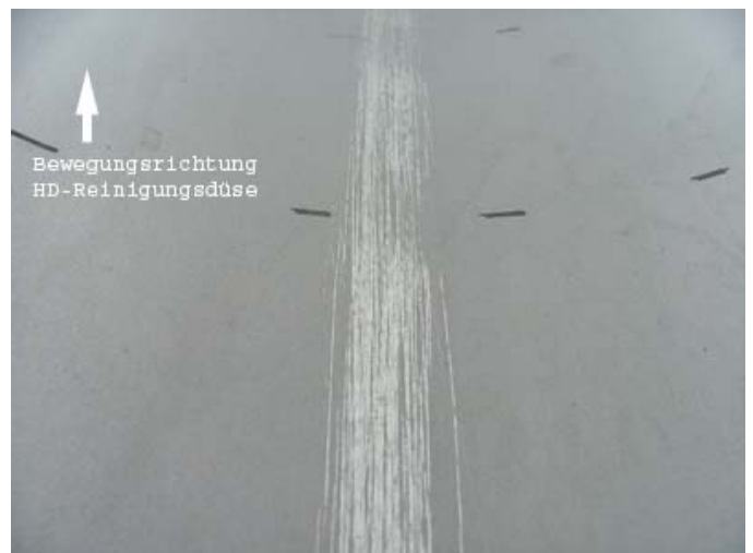
Probekörper 2 nach 30 Belastungszyklen
