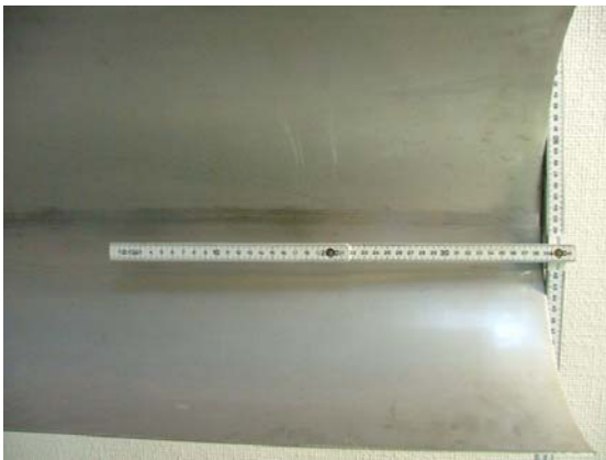
C 4 cm Breite Schleifspur
