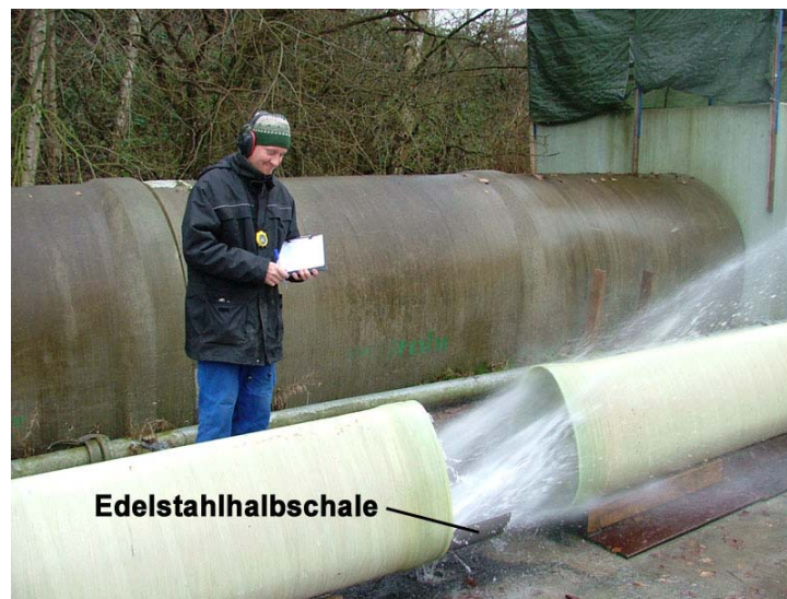
Die Abbildung zeigt die in ein GfK-Rohr eingebaute Edelstahl-Halbschale. Zur Durchführung der 30 Reinigungszyklen unter Zugabe von Prüfgeschibe wurde die Rohrverbindung zusammenschoben. IKT – eigene Darstellung.
