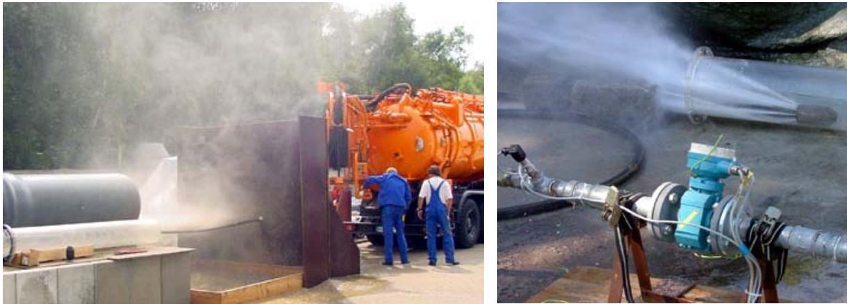
Bild 11: Einsatz von HD-Spülfahrzeugen im Räumversuch DN 800 (links); vor dem Versuch wurden die Betriebsparameter (Druck und Durchfluss) mit MID-Durchflussmessgerät und Druckaufnehmer für das jeweilige Düsensystem gemessen (rechts)
