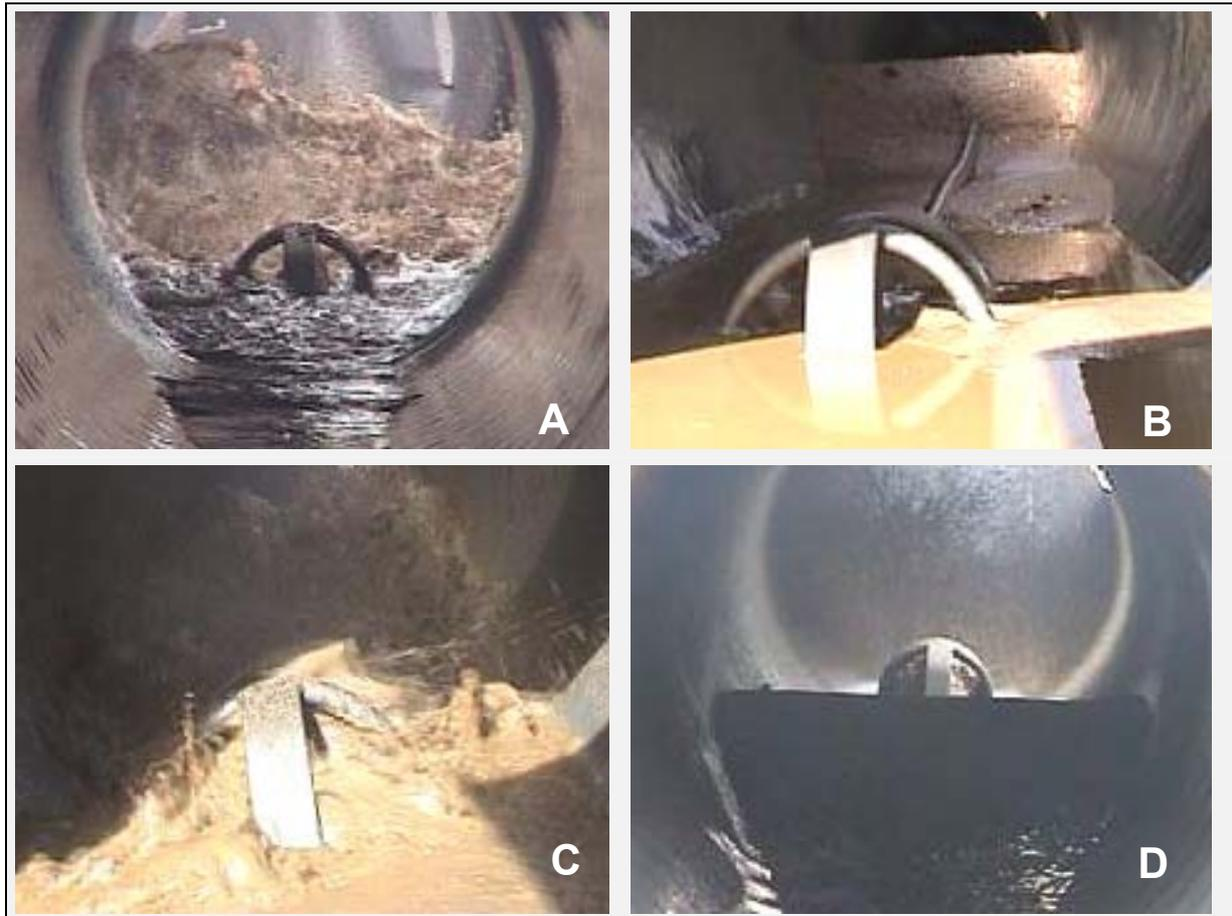
Bild 12: Transportversuche. A: Düse an der Leistungsgrenze. B: Situation bei abgestellter Düse. C: Düse versinkt im Rückstau. D: Düse überfährt Ablagerungen.
