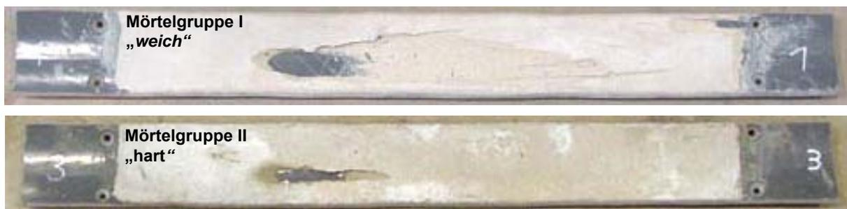
Bild 17: Abrasion an Modellsedimenten aus Mörtel durch stationären HD-Strahl
