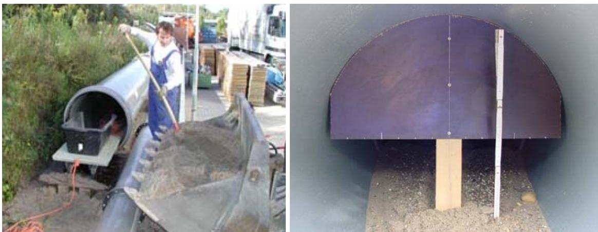
Bild 10: Versuchsstrecke DN 800: Befüllen der Versuchsstrecken mit Modellsedimenten (links), Füllstandskontrolle (rechts)
