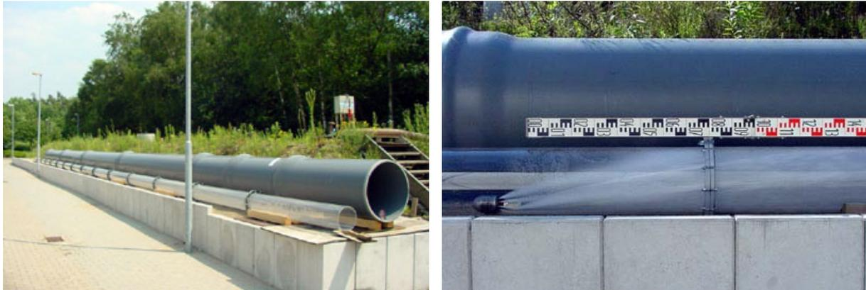
Bild 9: IKT-Prüfstrecken DN 300 (Plexiglas) und DN 800 (PVC)
