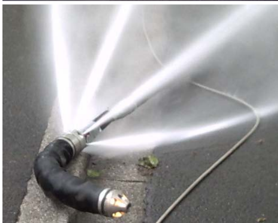
Bild 23: Inspektionsfahrzeug (o.) mit ZK Göttinger Kanalwurm im Spüleinsatz (u.) Bild 24: ORION L, Kieler Stäbchen, Beispiel mit Spüldüse zur Vorreinigung
