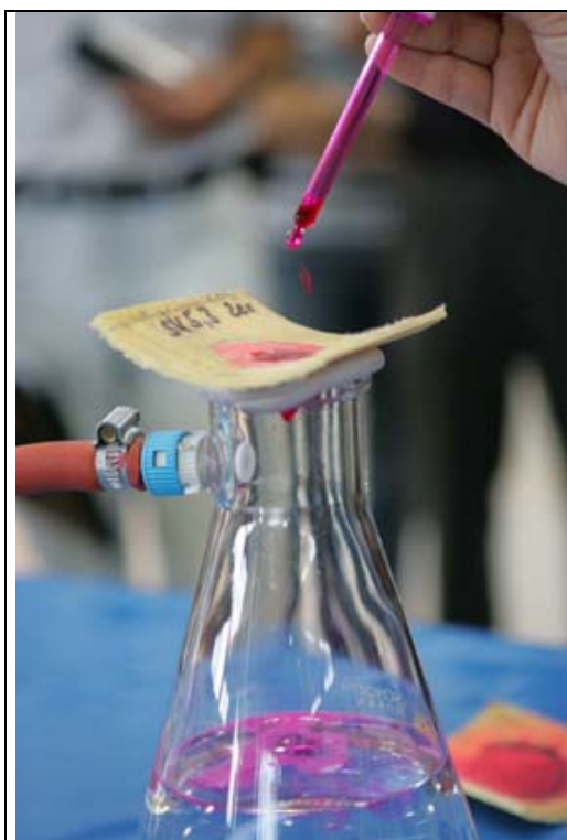
Kuva 3: Vettä (punaista) pisaroi läpi: sujutusputki ei ole tiivis
