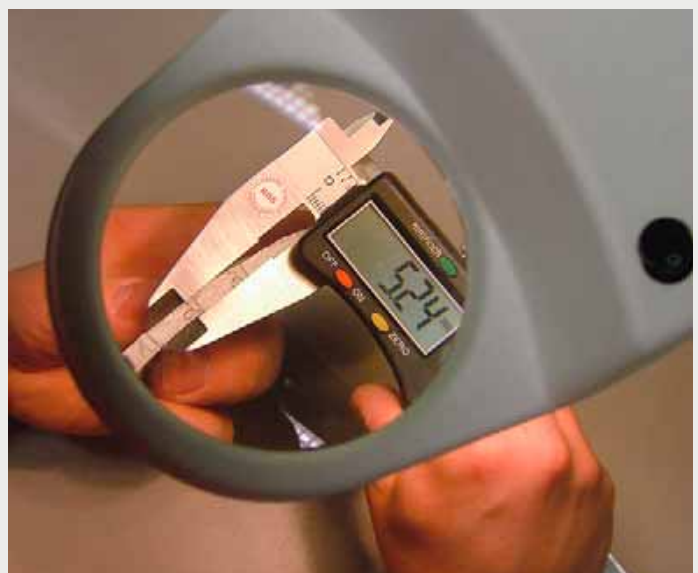
Figure 3 : Mesure de l'épaisseur de la paroi du liner
