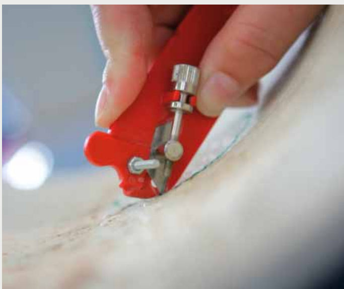
Figure 2 : Incision du film intérieur avec limitation de la profondeur d'incision
