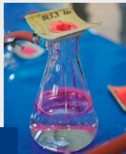
Figure 4 : Essai d'imperméabilité à l'eau
