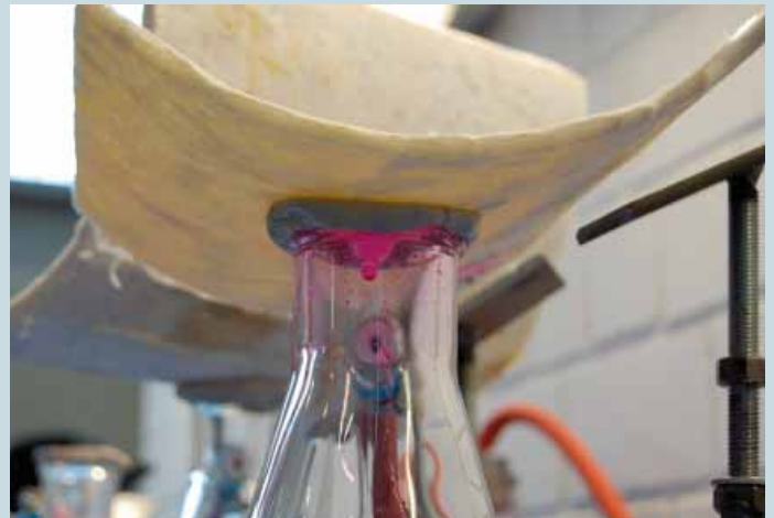
Dichtheitsprüfung: undichter Liner
