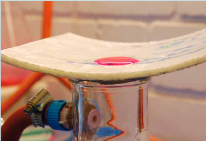
Dichtheitsprüfung: dichter Liner
