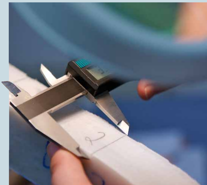
Mit Präzisionsschieblehre wird die Liner-Wanddicke gemessen
