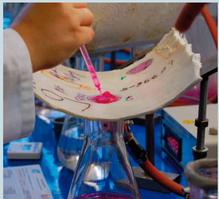
Dichtheitsprüfung: Gefärbtes Wasser wird auf die Innenseite des Liners aufgetragen
