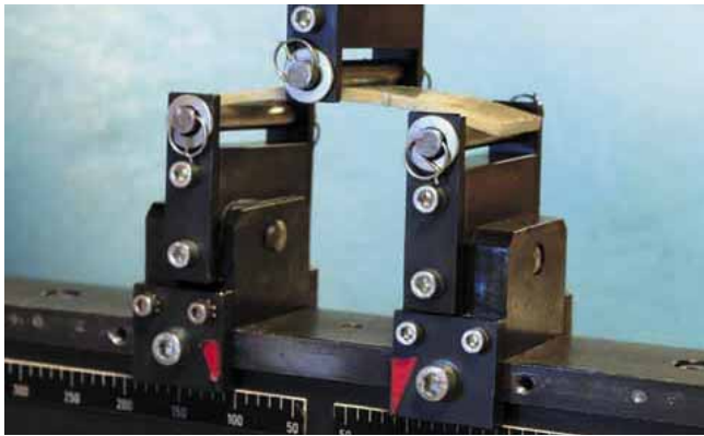
Ilustr. 1. Układ trzypunktowej próby na zginanie
