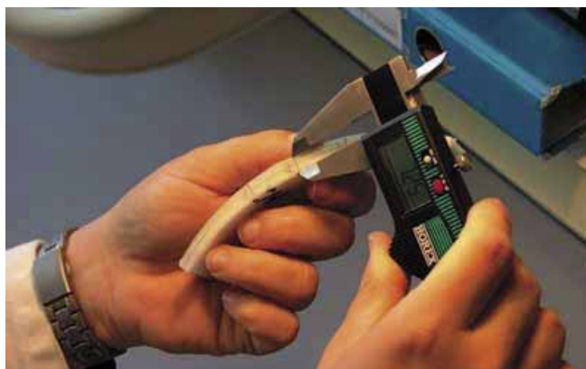
Ilustr. 3. Pomiar grubości ścianki linera
