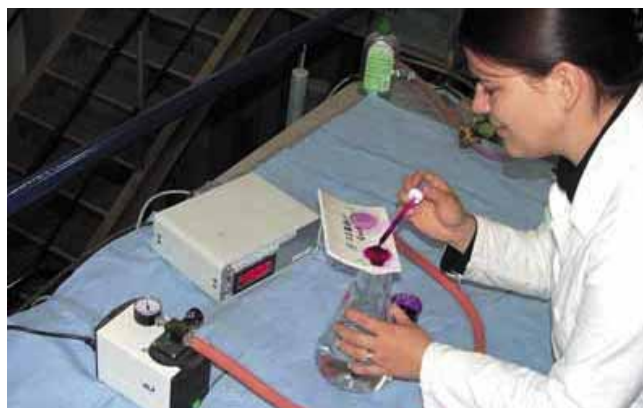
Ilustr. 4. Test na wodoszczelność przy podciśnieniu 0,5 bar
