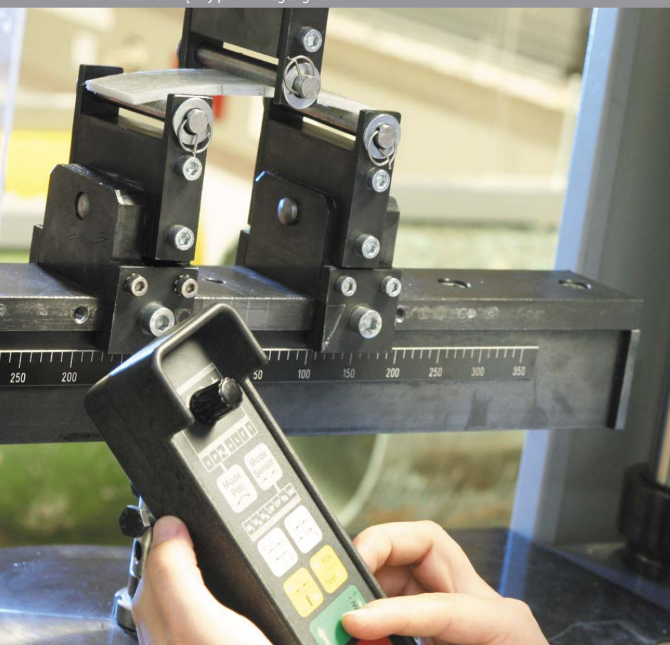
Fot. 4. Test metodą trzy punktowego zginania
