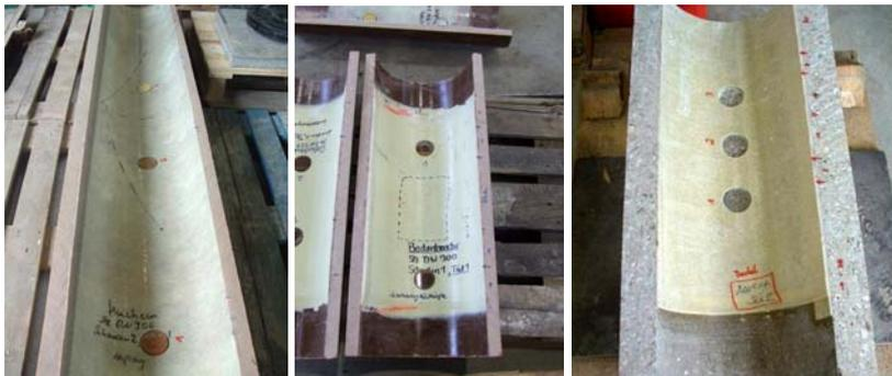
Abb. 13: Probekörper nach Haftzugprüfung
