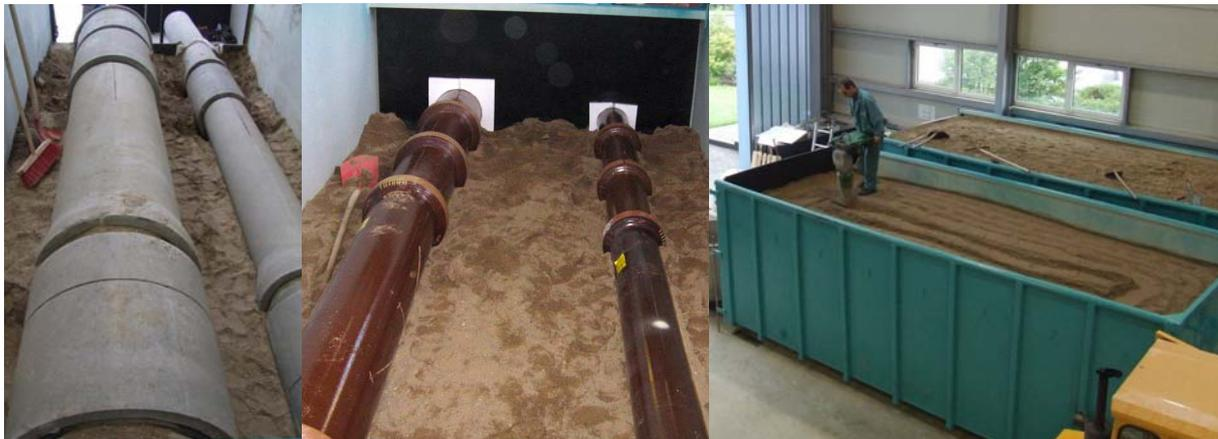
Abb. 3: Teststreckenaufbau für die Injektions- und Spachtel-/Verpressverfahren
