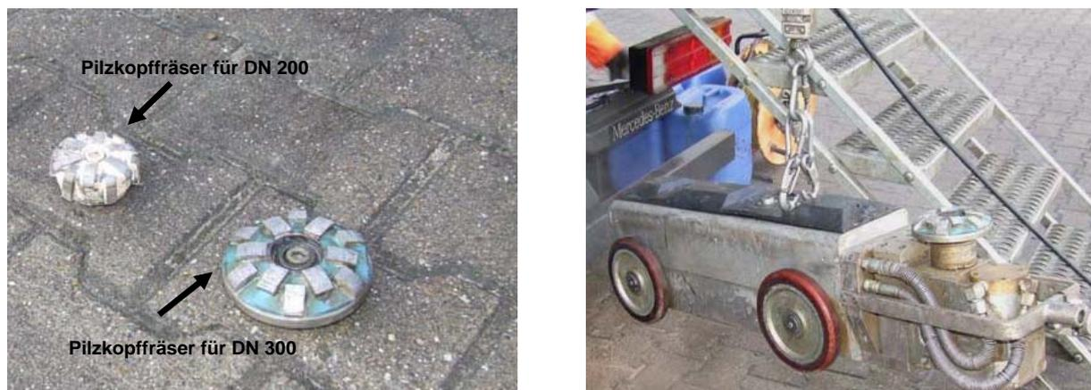
Abb. 38: Verwendete Fräsköpfe: „Pilzkopffräser“ (links), Fräsroboter für Nennweite DN 300 (rechts)
