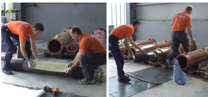
Abb. 16: Setzen eines Kurzliners für die ergänzenden Haftzugprüfungen
