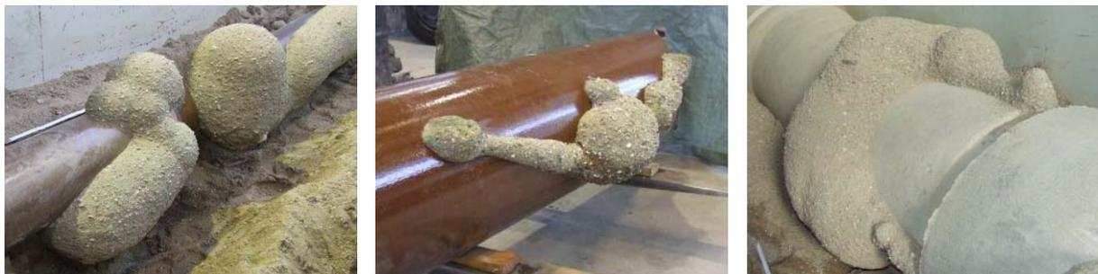
Abb. 19: Bildbeispiel – Detail Rohraußenseite nach Aufgrabung Stz. DN 200 (links), Stz. DN 300 (mittig), Beton DN 600 (rechts)
