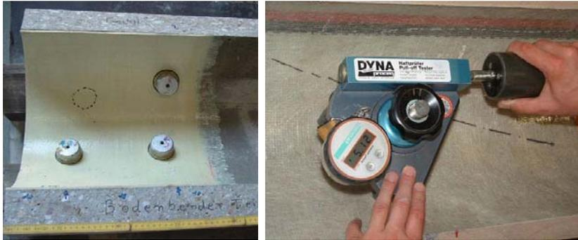
Abb. 12: Bohrungen mit aufgeklebten Prüfstempeln (links) und Haftzugprüfgerät während der Prüfung (rechts)
