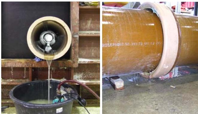
Abb. 11: Wasserzufluss bei Sanierung (links), Undichtigkeit der Muffe bei Wasserfüllung des Rohres (rechts)
