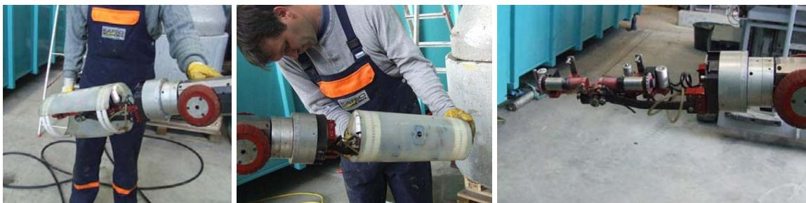
Abb. 24: Setzgerät mit Schalungsmanschette (links u. mittig) und Schalungssetzgerät-Vorbau des Roboters (rechts)
