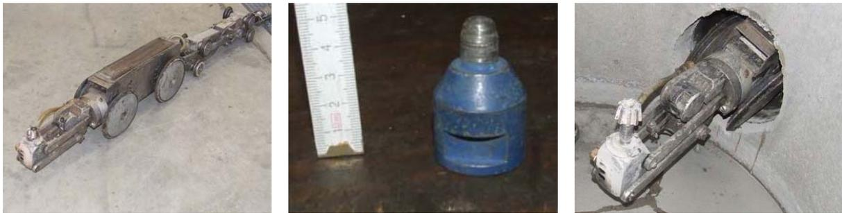
Abb. 48: Fräsroboter (links), Fingerfräser (mittig), Kegelfräskopf (rechts)
