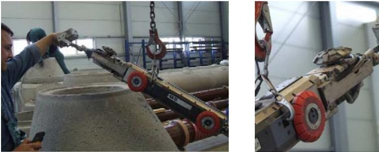
Abb. 35: Fräsroboter (links), „Pilzkopffräser“ (rechts)
