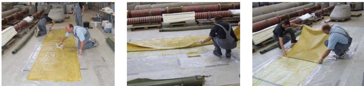
Abb. 33: Auftragen des Harzes mittels Spachtel (links), Wenden des Glasfasergewebes (mittig), Einschlagen des harzgetränkten Gewebes zur Mitte hin (rechts)
