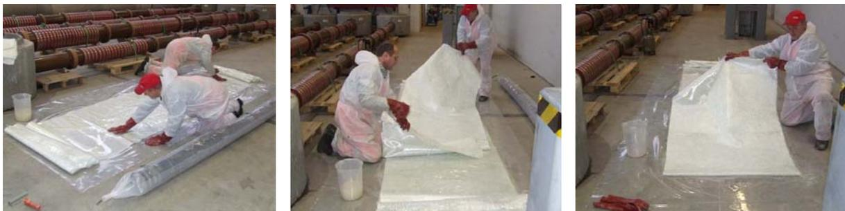
Abb. 39: Händisches Auftragen des Harzes (li), Auflegen der dritten Gewebelage (mi), Einschlagen des harzgetränkten Gewebes zur Mitte hin (re)
