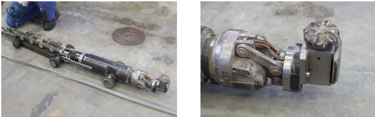
Abb. 43: Fräsroboter (links), verwendeter Fräskopf: „Tellerfräser“ (rechts)
