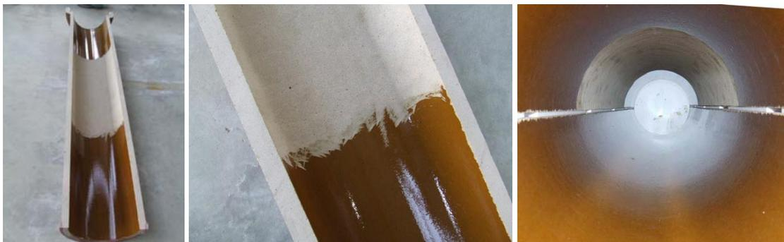
Abb. 15: Gefräste Oberfläche (links u. mittig), zusammengesetzte Rohrhalbschalen für die Sanierung (rechts)
