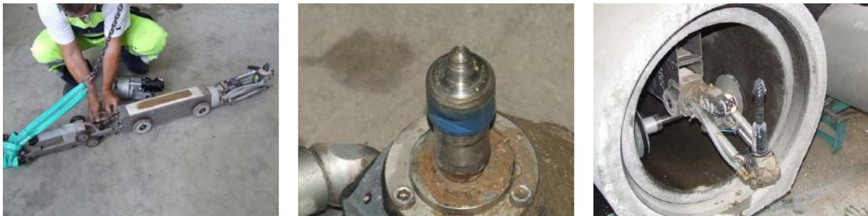
Abb. 20: Fräsroboter DN 200 mit Kegelfräskopf (links), Fingerfräskopf (mittig), Fräsroboter DN 600 mit Kegelfräskopf (rechts)
