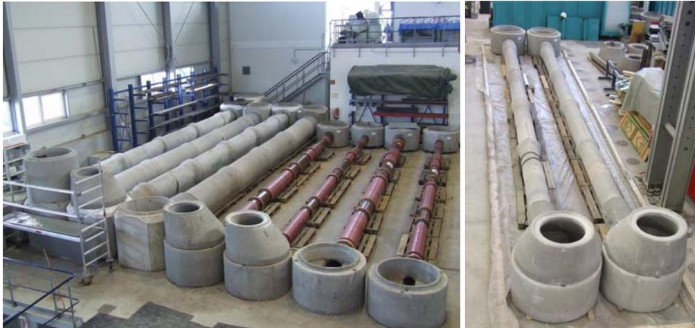
Abb. 4: Teststreckenaufbau für die Innenmanschetten und Kurzliner
