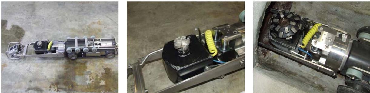
Abb. 32: Fräsroboter (links), „Diamantpilzkopfräser“ für DN 200 (mittig), „Diamantpilzkopfräser“ für DN 300 (rechts)
