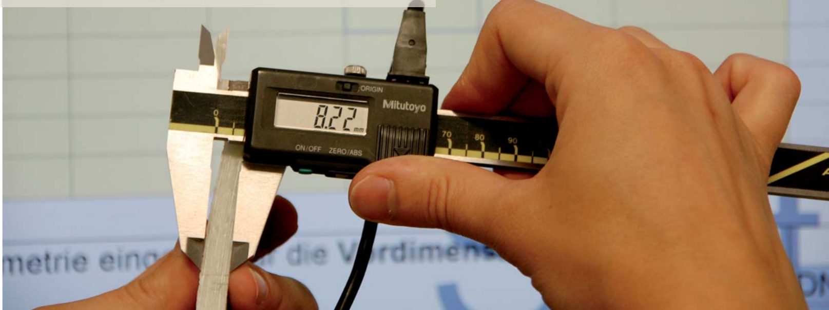
Mit Präzisionsschieblehre wird Liner-Wanddicke gemessen
