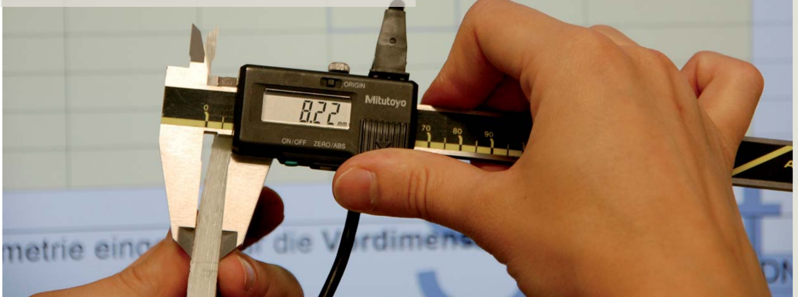
Mit Präzisionsschieblehre wird Liner-Wanddicke gemessen
