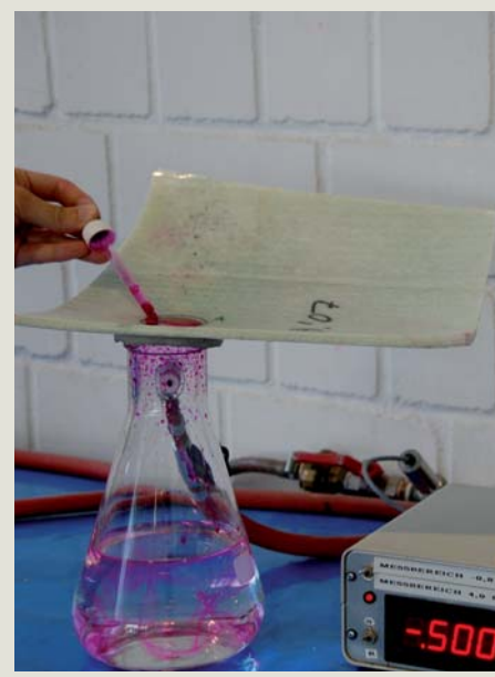
Dichtheitsprüfung: undichter Liner
