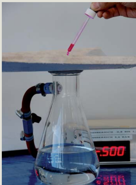
Dichtheitsprüfung: Rot gefärbtes Wasser wird auf die Innenseite des Liners aufgetragen
