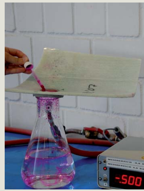
Dichtheitsprüfung: undichter Liner
