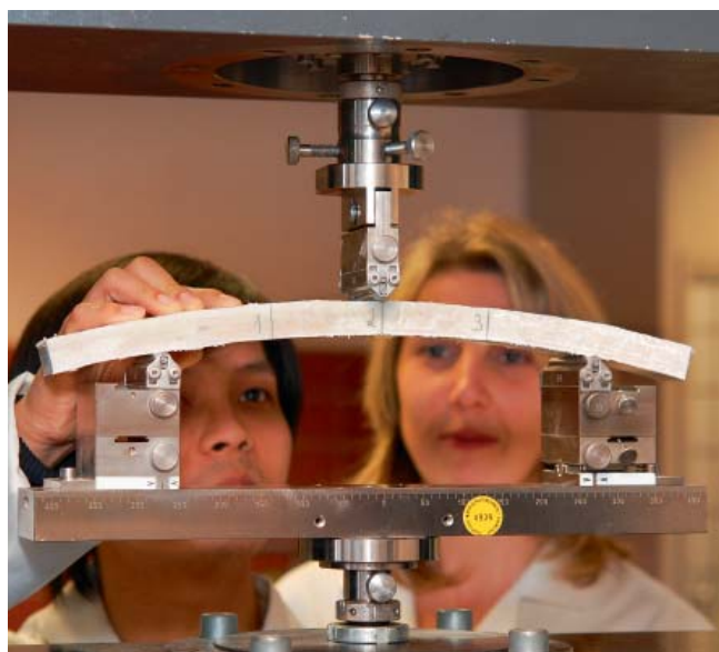
Fot. 3. | Przy pomiarze wytrzymałości na zginanie średnia ilość spełnionych wymagań była podobna, jak rok temu. Badanie wykładziny DN1500
