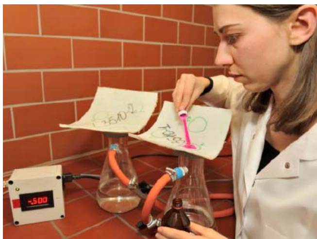
Fot. 3. Pomiar szczelności wykładziny ISO 11296-4
