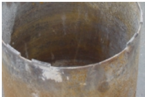
Fehlende Bohrzacken an der Bohrkronen
