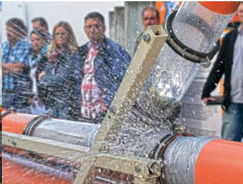
Spritzig: Am gläsernen Kanal läßt sich die Funktionsweise der Spezialdüse am besten demonstrieren.
