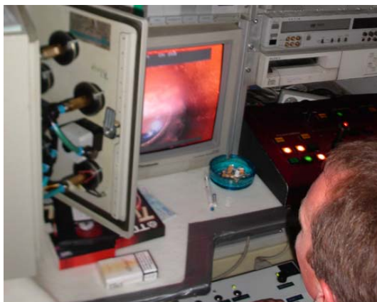
Abb. 3: Überwachung der Sanierung durch den Techniker im Sanierungsfahrzeug
