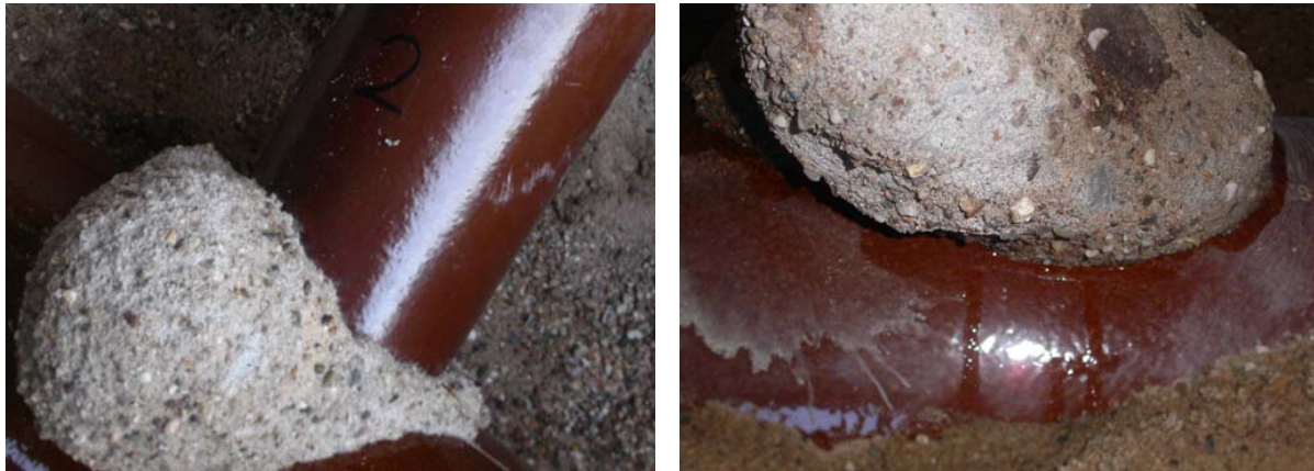
Abb. 9: Bsp. Dichtheitsprüfungen am Standardschaden: a) dichte Reparaturstelle 2; b) undichte Reparaturstelle 3 nach Belastung durch Hochdruckreinigung
