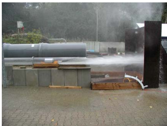
Bild 2: Sehende Düse im IKT Plexiglaskanal DN 300
