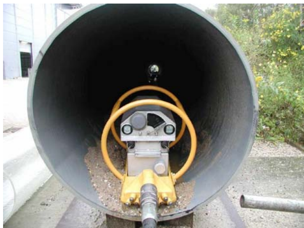
Bild 3: „Sehende Düse“ Startstellung (Nennweite DN 800)
