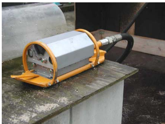
Bild 1: Sehende Düse der Firma KEG
