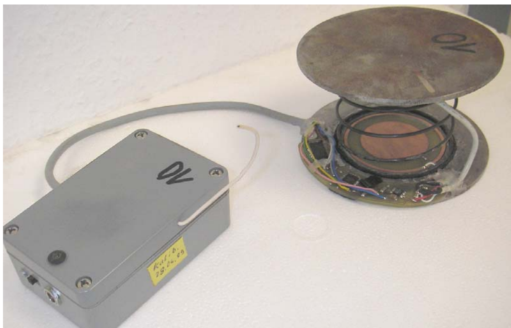
Bild 8 Modifizierte Messdose ohne äußeren und inneren Schutzmantel
