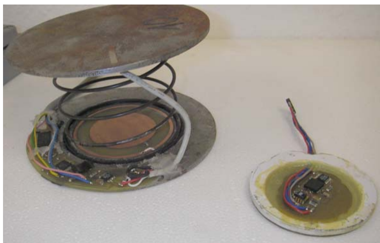
Bild 20 Elektronik im Vergleich: Prototyp (links) und platzsparende Modifikation (rechts)
