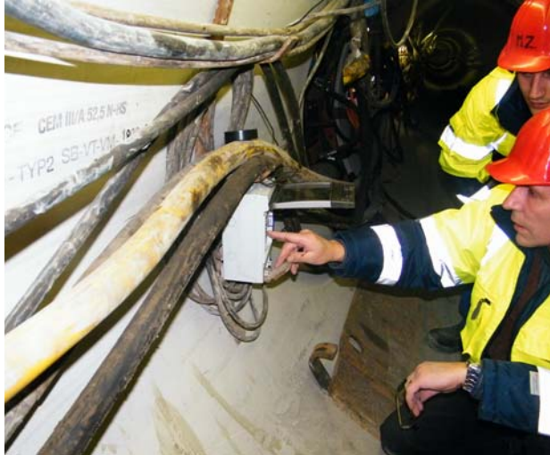
Bild 11: Master auf Microcontrollerbasis zur Steuerung, Abfrage, Visualisierung und Speicherung der Messwerte
