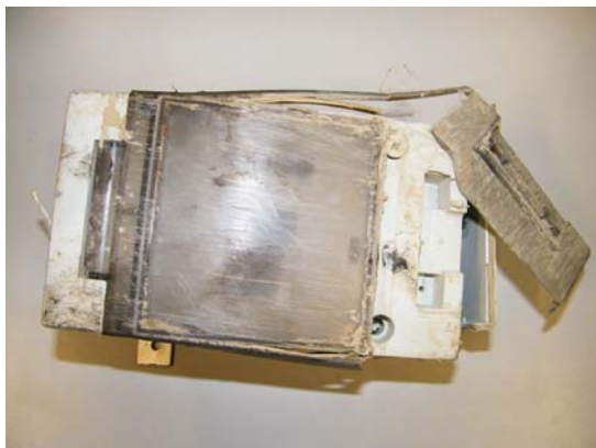
Bild 12: Zerstörter Master auf Microcontrollerbasis
