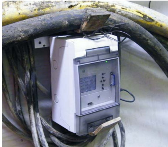
Bild 11: Master auf Microcontrollerbasis zur Steuerung, Abfrage, Visualisierung und Speicherung der Messwerte
