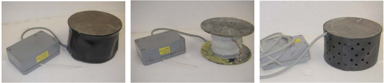
Bild 18 Darstellung der unterschiedlichen Prototypen: Ursprungsversion (links), Gekapselte Version (mitte) und Offene Version (rechts)
