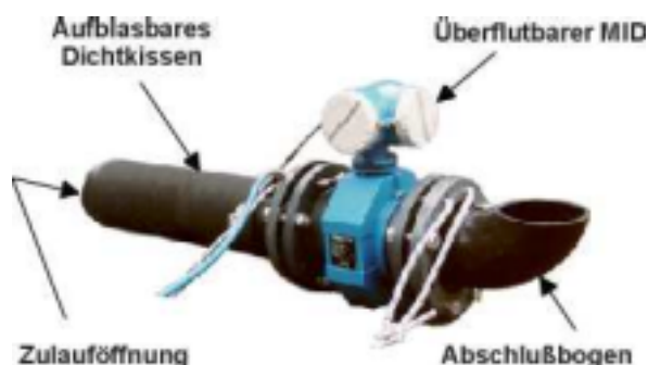
Abb. 4: Transportable MID-Messeinrichtung für Fremdwassermengenermessungen
