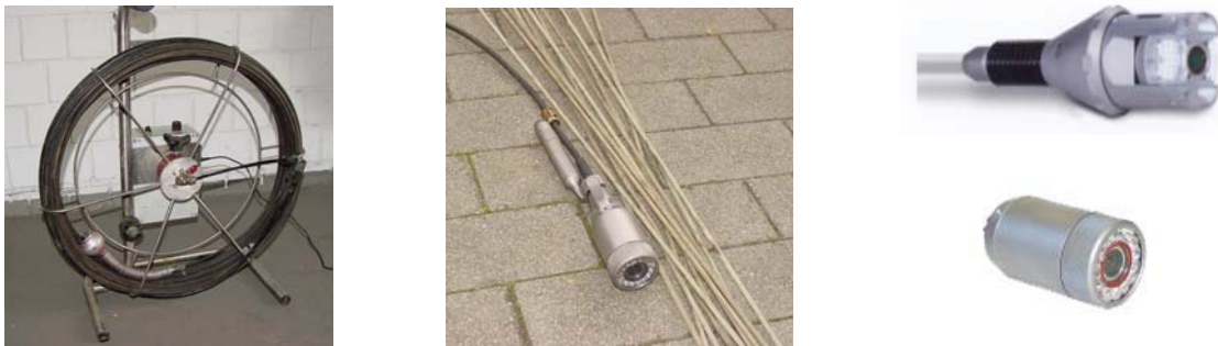
Bild 6: v.l.: Kamera mit Röhrenaal, Kamera mit Schiebestangen, Schwenkkopf (oben) und Axialkopf (unten) [13]
