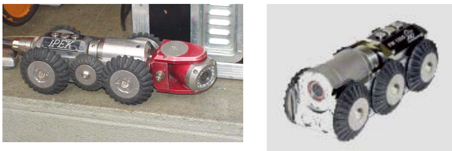
Bild 7: Fahrwagen mit Schwenkkopfkamera (links) und Axialkopfkamera (rechts) [13]
